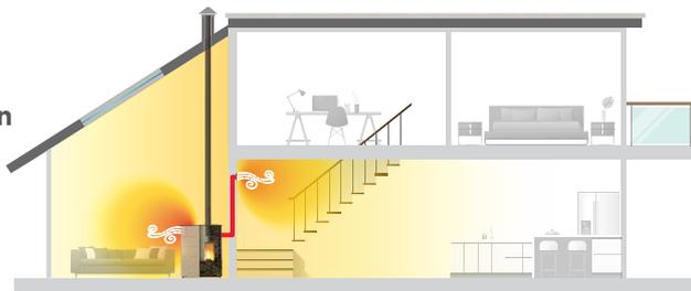
Les modèles dotés du Twin Air System ajoutent à la fonction de l'air ventilé, la possibilité de dévier le flux de l'air chaud dans une deuxième pièce (jusqu'à 8 m de canalisation linéaire) : une solution parfaite pour chauffer deux pièces adjacentes.
