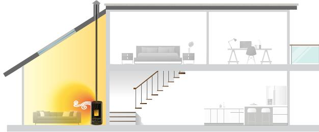
Les poêles Ecofire® à air ventilé sont dotés d'un ventilateur qui achemine rapidement l'air chaud produit par la combustion dans toute la pièce. Grâce à l'unité de contrôle, il est possible de gérer la puissance du poêle et la vitesse du ventilateur en fonction des besoins de chaleur personnels.
